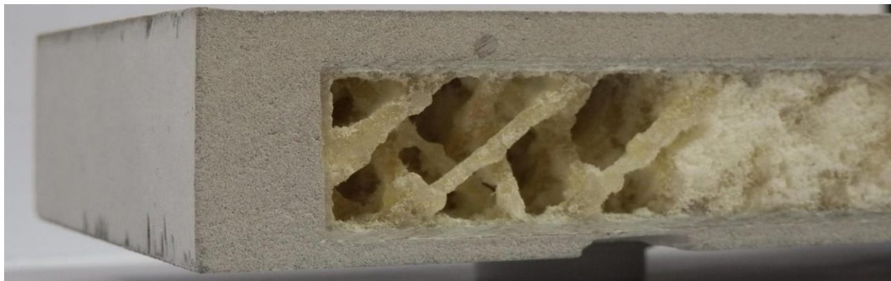
Prototype de panneau sandwich à peau minérale, propriété LMC 2 /SAERTEX
